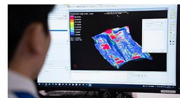
3D CADで製品、付属部品を含めた製品設計を行います。同時にCAE解析により成形性の確認等も併行で行い、品質の向上を常に目指しています。
